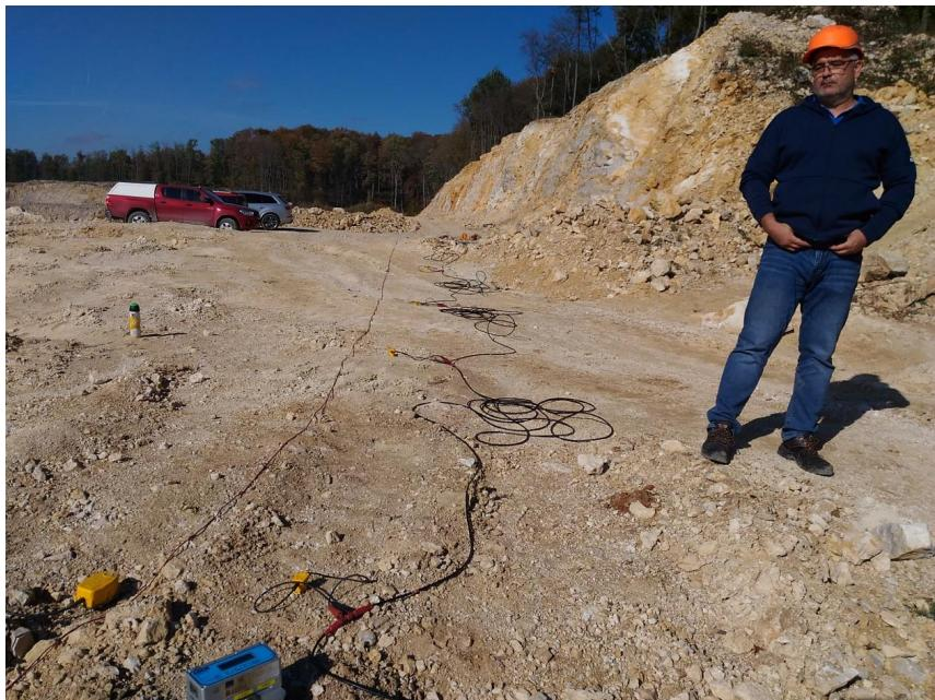
Obr. 8 Sezimicky profil na lomovej stene pred odstrelom. 24 geofónov bolo rozmiestnených s krokom 2 m do vzdialenosť 48 m
