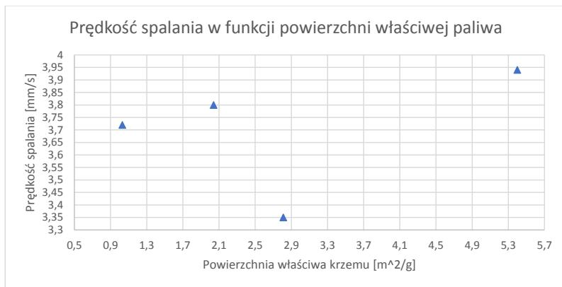
Rys. 3. Prędkość spalania w funkcji powierzchni właściwej paliwa [15].
