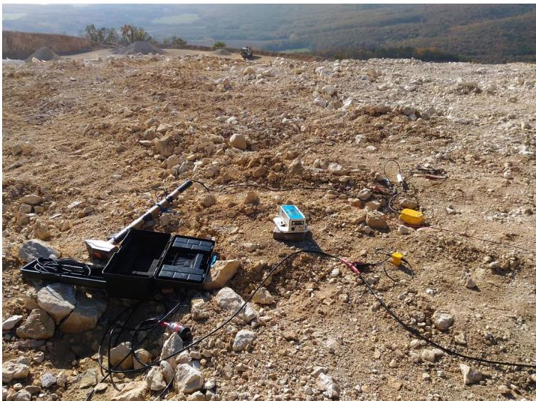
Obr. 5 Meracie stanovisko 1 v lome Mnichová Lehota vo vzdialosti 18,5 m od iniciačného vrtu so situovaním trojzložkového snímača Vibraloc od firmy ABEM na špeciálnej podložke
