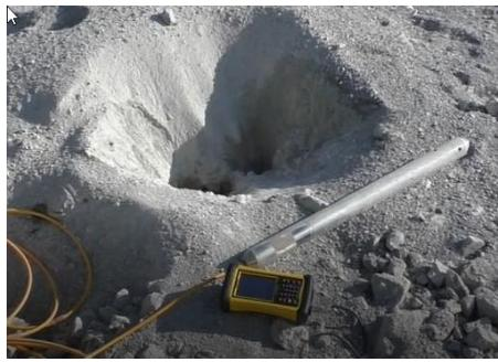
Meranie detonačnej rýchlosťi- Microtrap      Meranie seismiky MINI SUPERGRAPH II
