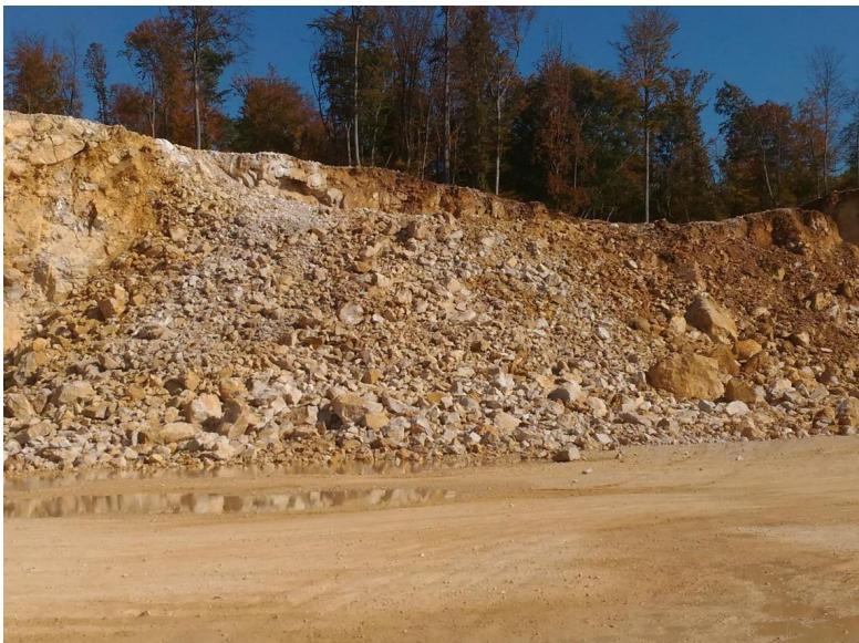
Obr. 12 Rozval po clonovom odstrelu 561/ML/19 v lome Mnichová Lehota
