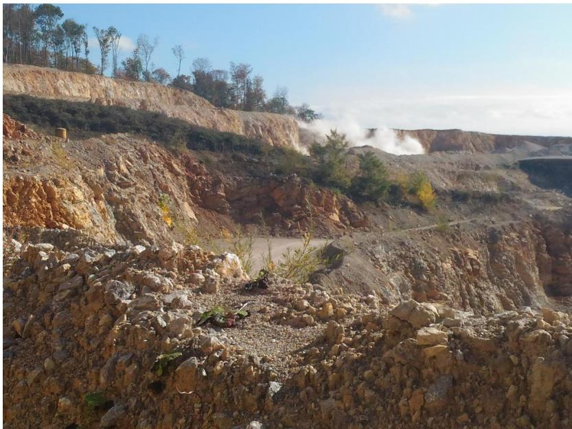
Obr. 4 Pohľad na jednotlivé etáže lomu Mnichová Lehota s viditeľnou vysokou mierou porušenia horninového masívu a miesto trhacích prác
