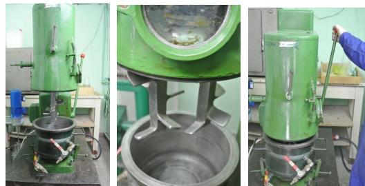
Rys. 5. Mieszalnik planetarny typu DRAIS
