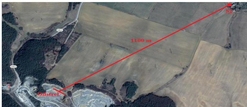
Obr. 5 Pozícia a vzdialosť clonového odstrelu v lome Sedlice voči meraciemu stanovisku - obytný dom v obci Sedlice
